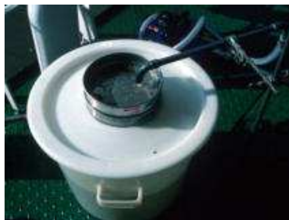
Bild 4 Abtrennen der Sandfraktion mit Hilfe des 50 µm Siebes
